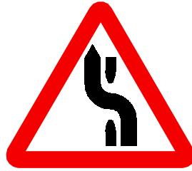
شکل ۳-۶۳- انتقال مسیر ترافیک در راه میانه‌دار
