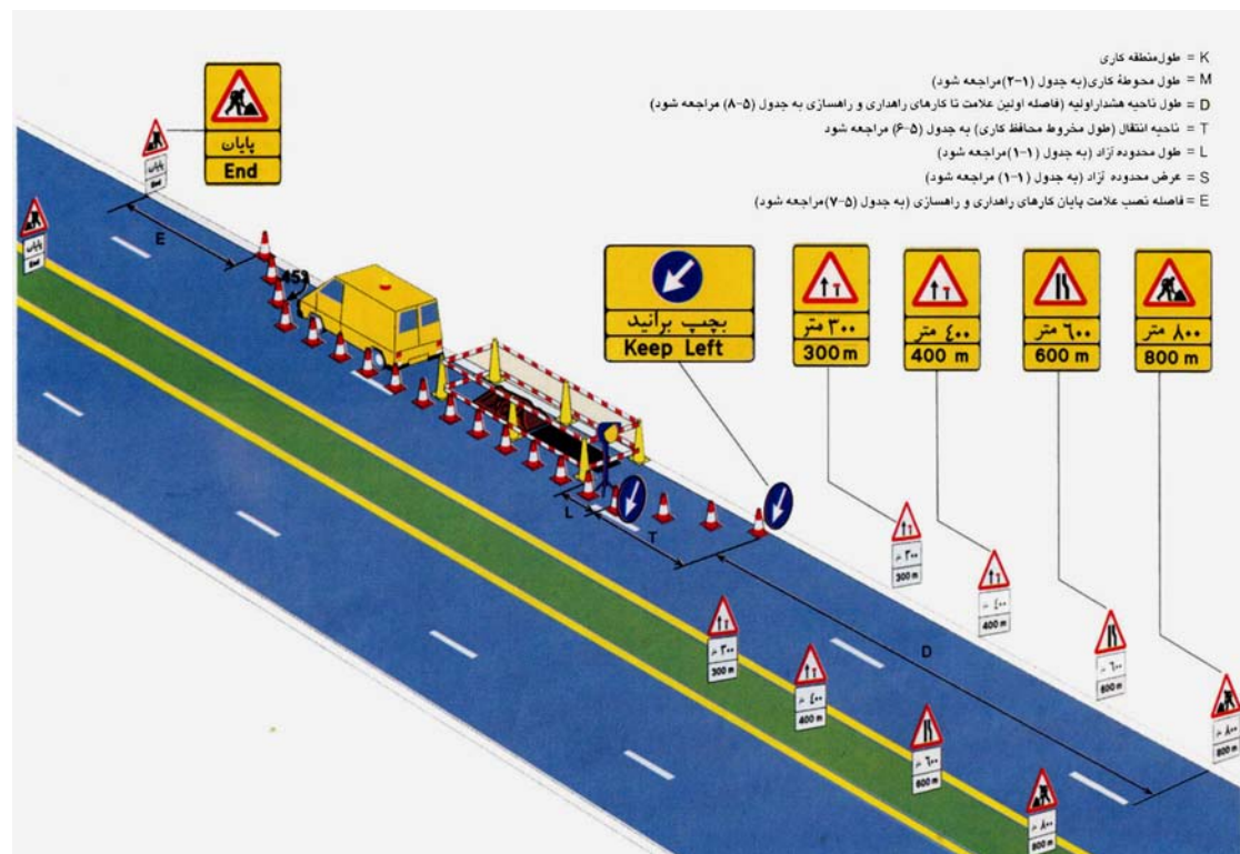
شکل ۲-۱۱- طرح علائم‌گذاری در یک راه شریانی چهارخطه با جدا کننده وسط که یک خط کناری آن بسته است.
